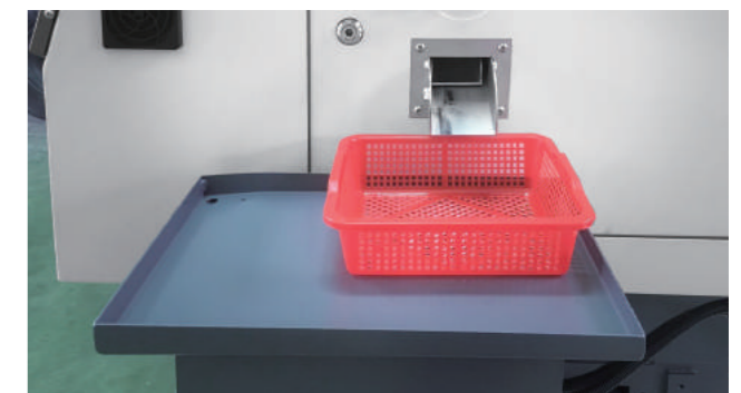
長工件取料裝置(選配) Long workpiece parts catcher(opt)
