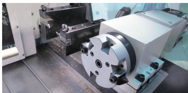
多邊銑動力裝置(選配) Polygon milling cutter device(opt)
